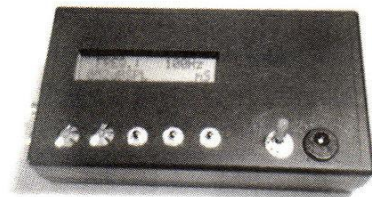
〈写真9〉リスニング・ルームの残響時間測定器
